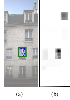
FIG. 5 – Localisation des fenêtres (a) Un chemin et sa région d'intérêt. (b) Image J obtenue par accumulation des régions d'intérêt.
